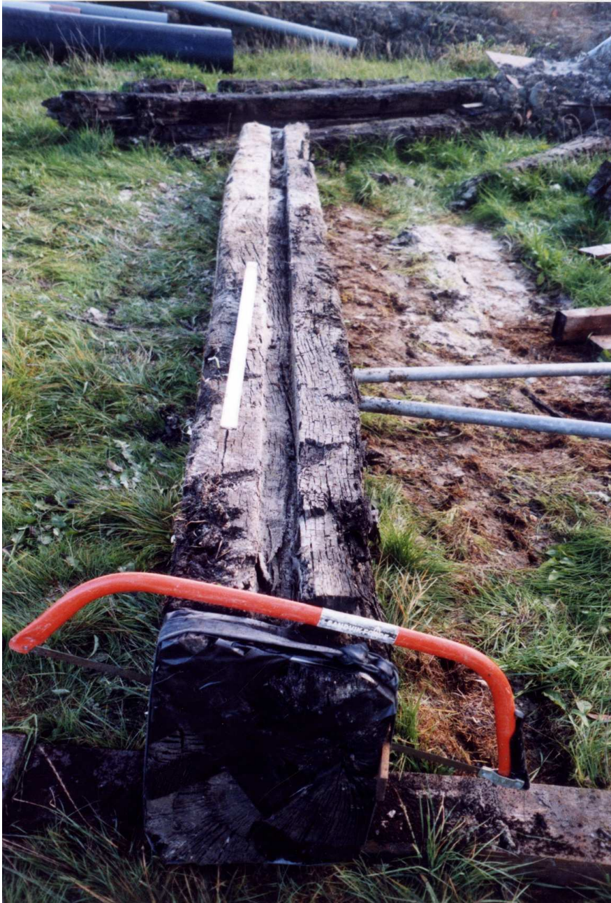
Afbeelding 2.8 Balk met sleuf van de eerste Schaphalsterzijl tijdens het zagen van monsters voor de dendrodatering. Foto: A. Ufkes.
