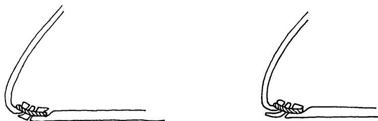
Afbeelding 5.5 Voorbeeld van een keernaad of retourné. Uit: Goubitz 2001, fig. 4.
