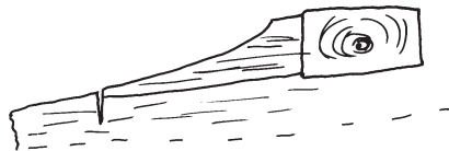
Afbeelding 2.17 Doorsnede van de klamp tegen de afsluitbalk. Aan het uiteinde is een kleine inkeping gemaakt, schaal 1:20.
