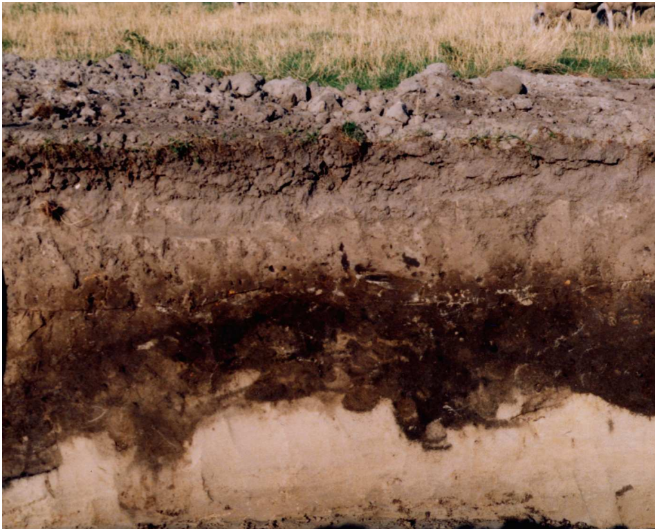
Afbeelding 3.9 Een uit veen bestaande verstevigingslaag op duinzand. Foto H. Halıcı.
