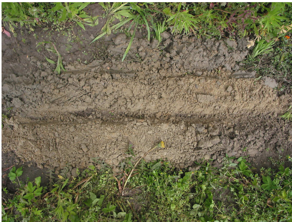
Afbeelding 4 Boring 1: onderste kolom van rechts naar links 0–1 m, middelste kolom van rechts naar links 1–2 m, bovenste kolom van rechts naar links 2–2,5 m. Foto: J.Y. Huis in 't Veld.
