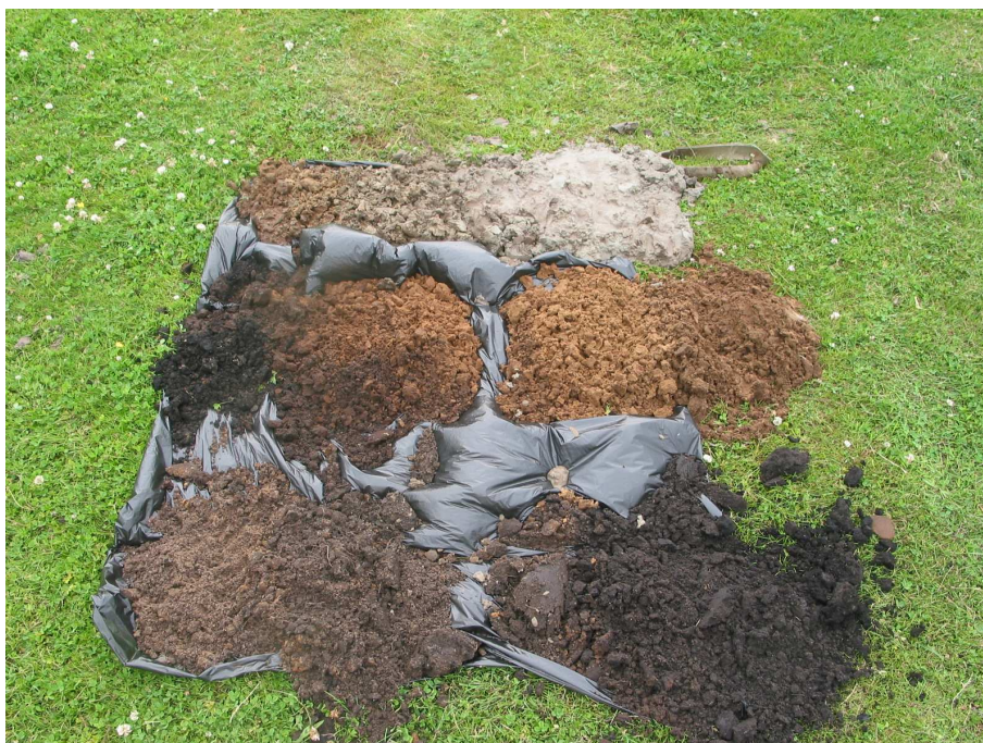
Afbeelding 4 Een voorbeeld van een boring van links naar rechts uitgelegd in stukken van 1 meter. Foto: H. Buitenhuis.
