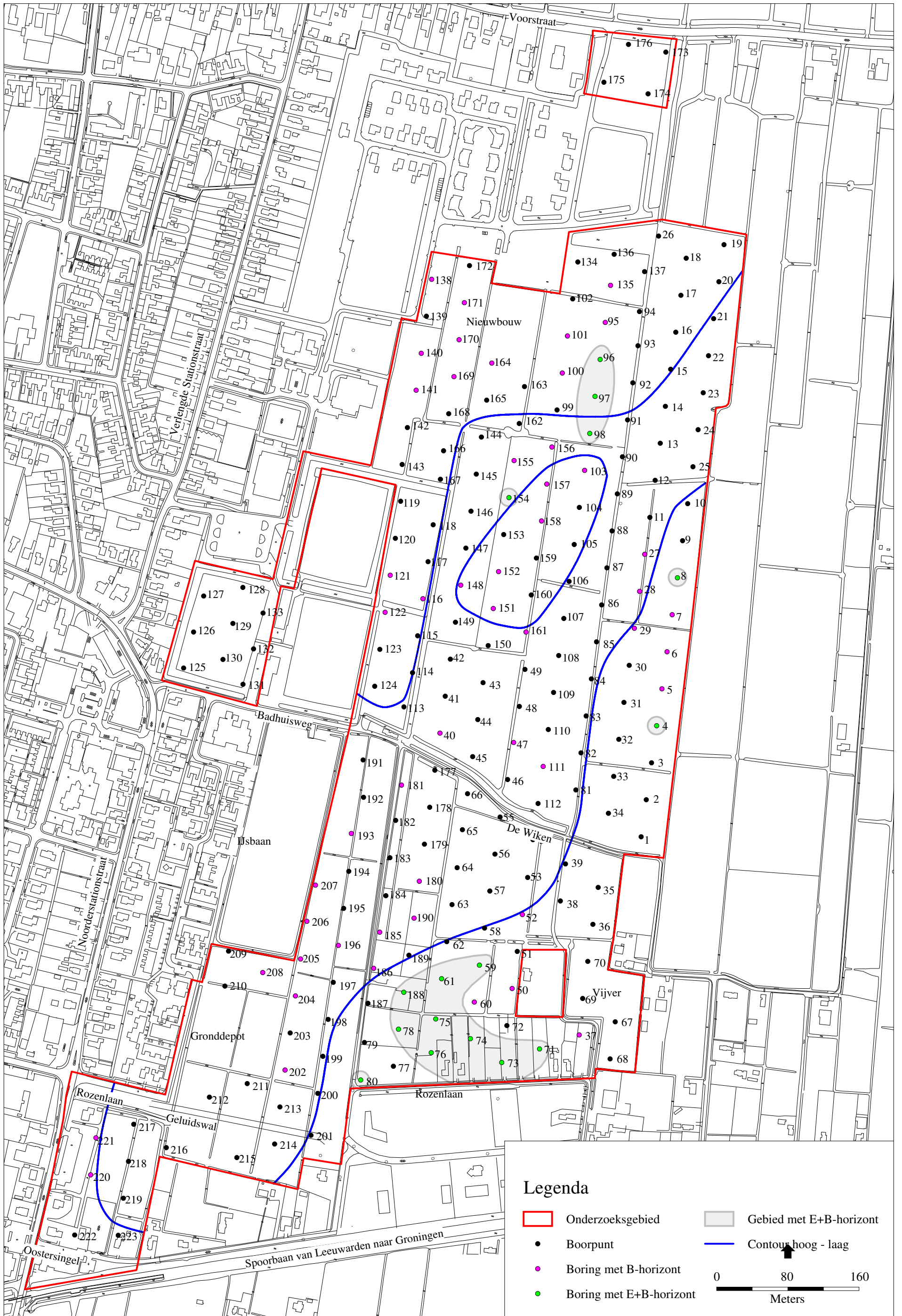
Bijlage 4 Ligging van de boorpunten waarbij de B-horizonten in kleur zijn aangegeven. Kaart: B. Schomaker.
