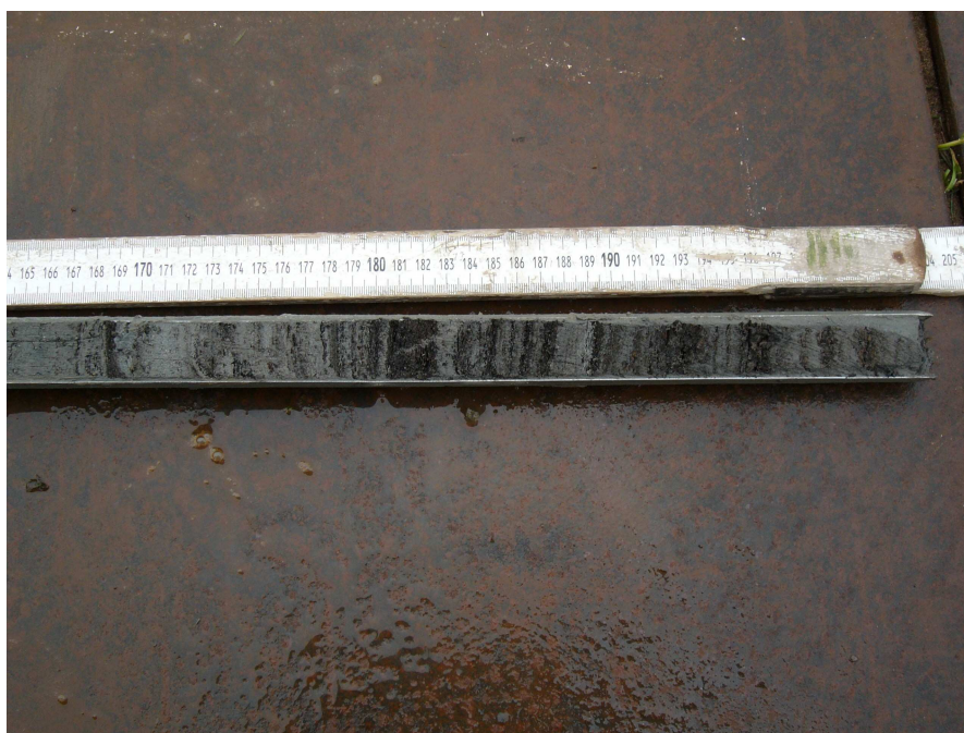
Afbeelding 3 Detail van de afwisselende silt-, zand- en veenlaagjes in boring 2 (1,65 tot 2,05 –mv). Foto: A.J. Wullink.
