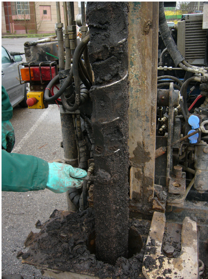
Afbeelding 7 Fragment van het bodemprofiel in boring 16. Foto: B. Silkens.
