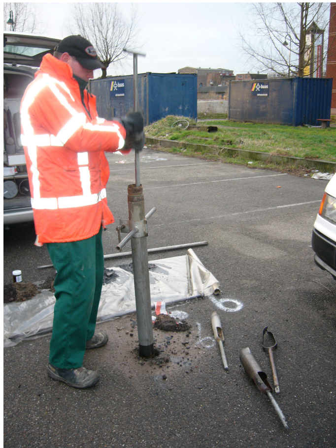
Afbeelding 3 Het gebruik van grondbuizen bij het manueel boren op het Bolwerk. Foto: B. Silkens.
