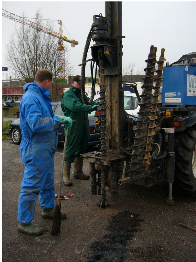
Afbeelding 5 Mechanisch boren met volle avegaren. Foto: B. Silkens.
