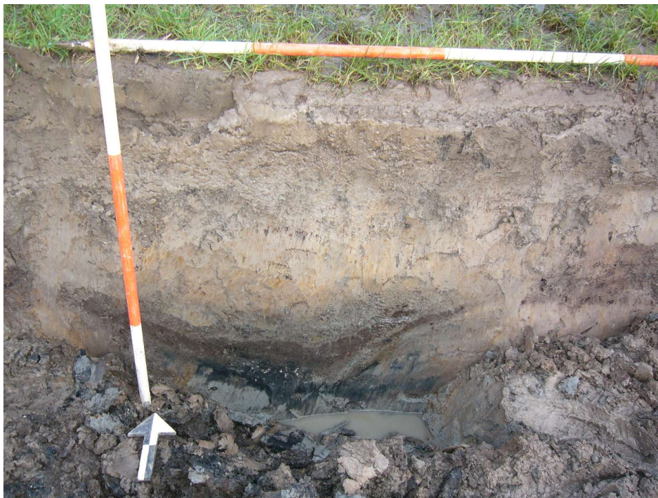
Afbeelding 9 Foto van profiel in het zuiden op westflank (P3) met dunne veenlaag en kleilaag. Foto: J.J. van Ams
