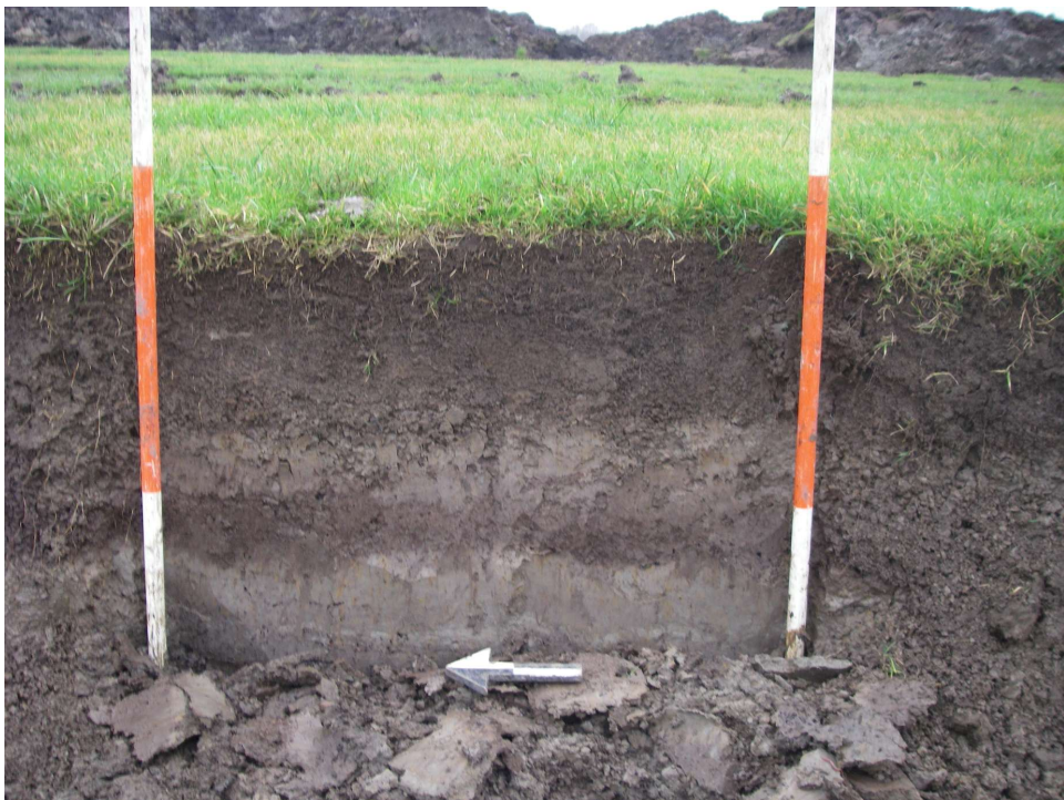
Afbeelding 12 Foto van profiel in het zuiden op westflank (P2) met dunne veenlaag en kleilaag. Foto: J.J. van Ams
