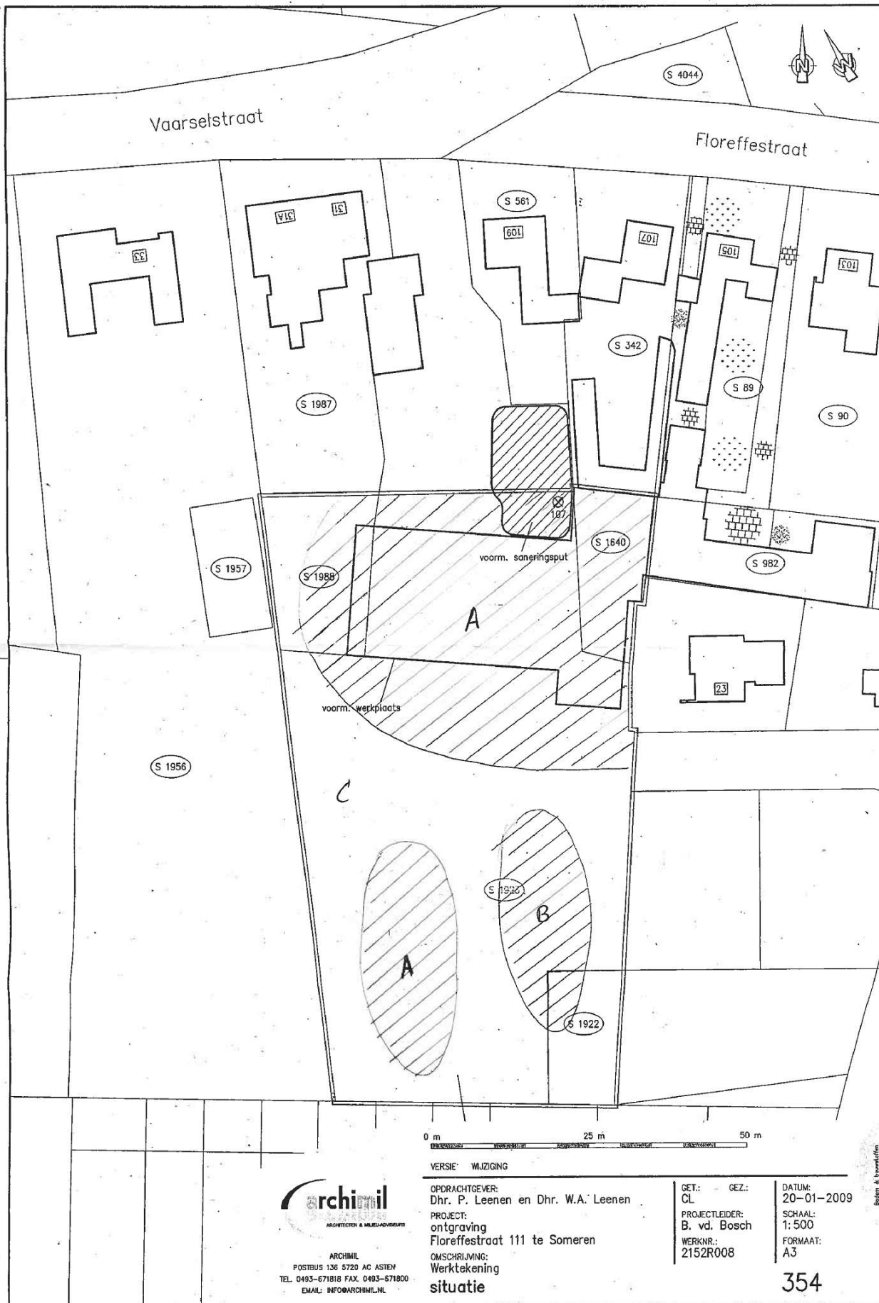
Bijlage 7 Ontgravingsdiepte ten behoeve van van sloop en sanering oostelijk deel van de onderzoekslocatie. Ontgravingsdieptes voor de delen A, B en C bedragen respectievelijk ca. 2,5 m -mv, 1,0 m -mv en 0,5 m -mv. Bron: Dhr. P. Leenen, Someren.
