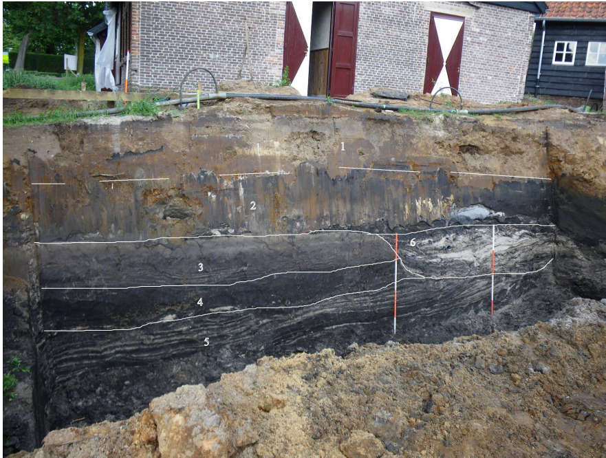
Afbeelding 9. Voortzetting van het noordelijke profiel. 1= bouwvoor en opgebracht zandpakket; 2= niet opgeschaafd – gelaagd zandpakket; 3= gelaagd zandpakket met humeuze banden; 4= humeus venig zand; 5= gelaagd zandpakket: overstromingszanden; 6= ingraving: overstromingszanden.
