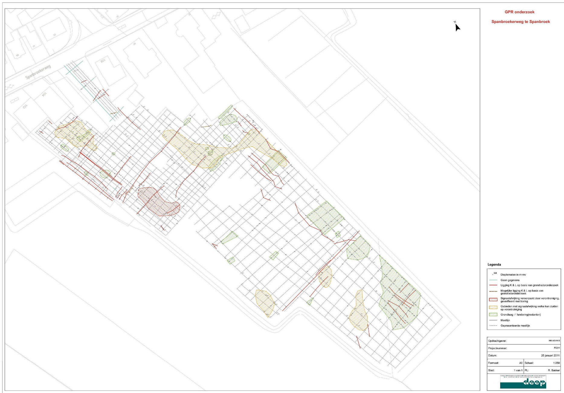
Afbeelding 5. Grondradark kaart van de onderzoekslocatie. Bodemverontreiniging is in geel en rood weergegeven, puinresten/funderingsrestanten in groen. De rode lijnen geven de ligging van kabels en leidingen weer. Bron: DEEP bv.
