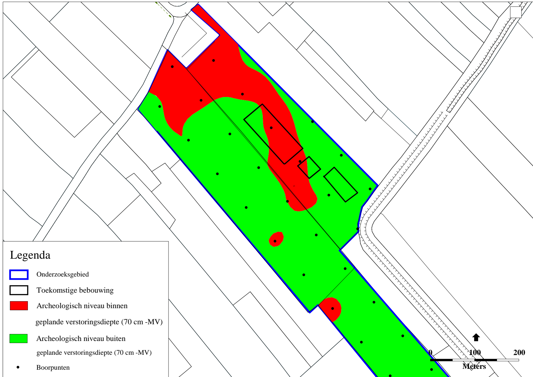
Afbeelding 16. Maximaal mogelijke versoringsdiepte in relatie tot de funderingsdiepte van 70 cm -mv. Door: M. Botermans
