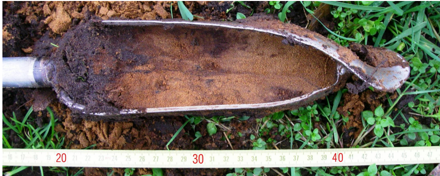
Afbeelding 3. Overgang van de bouwvoor naar de C-horizont in boring 3.
