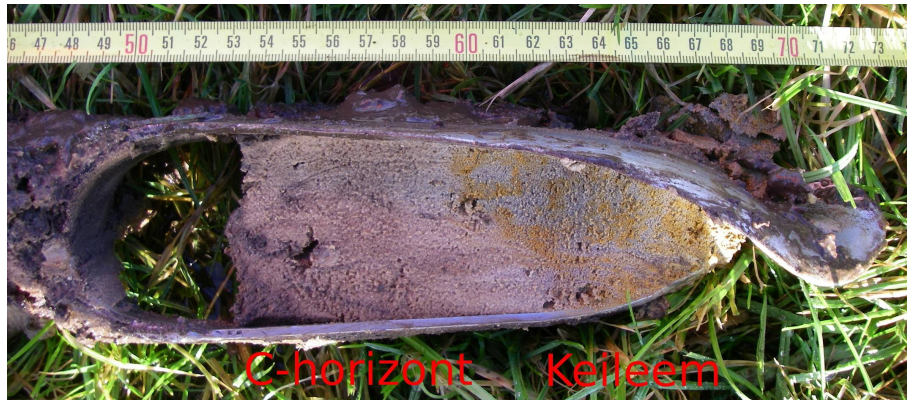
Afbeelding 4. Scherpe overgang van de C-horizont naar keileem in boring 102.
