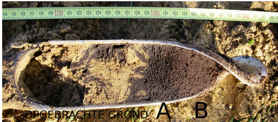
Afbeelding 2. Overgang van de oude bouwvoor naar de B-horizont in boring 138.
