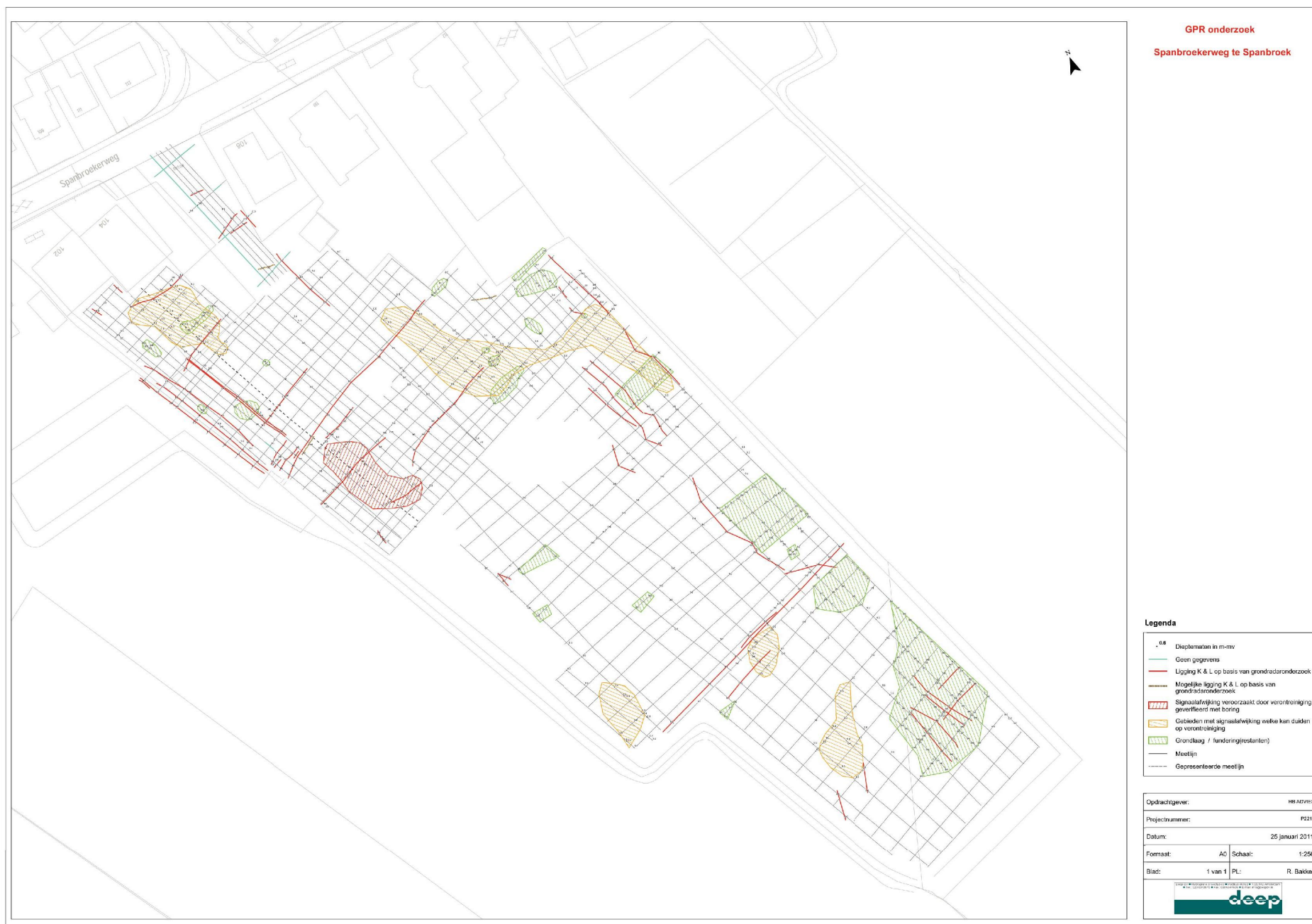
Afbeelding 3. Grondradarkarta van de onderzoekslocatie. Bodemverontreiniging is in geel en rood weergegeven, puinresten/funderingsrestanten in groen. De rode lijnen geven de ligging van kabels en leidingen weer. Bron: DEEP bv.
