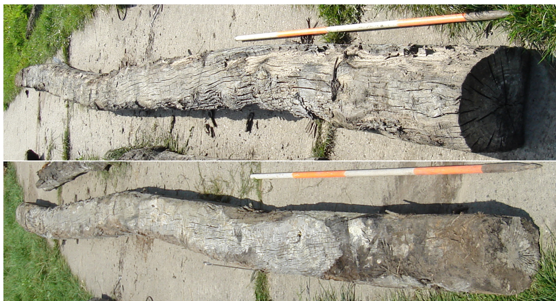
Houtnr 029, foto's vanaf beide einden. Enigzins afgevlakte boomstam, lengte 4,45 m, doorsnede 33 cm. Dit het langste samenstellende deel van de aan de oostzijde verwijderde onderslagbalk. Van deze balk is een monster genomen, vnr. 008
