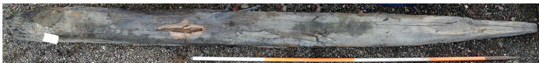
Houtnr 001, vierkant gekapt, hoeken afgeschuind, lengte 3,88 m, doorsnede 27 cm.
