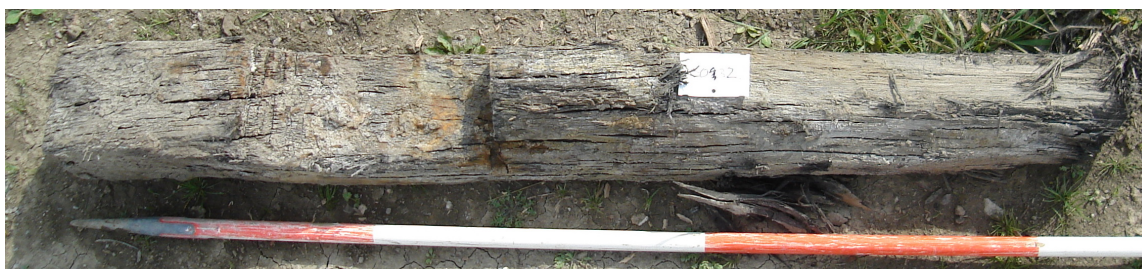
Houtnr 032, vierkant gekapt, lengte 1,77 m, doorsnede 19 cm. In de inkeping het restant van een ingeslagen nagel
