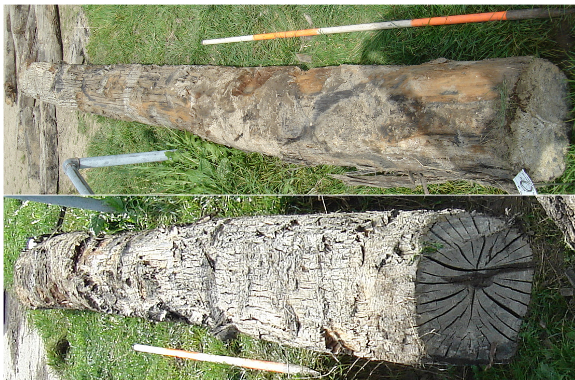
Houtnr 030, foto's vanaf beide einden. Enigzins afgevlakte boomstam, lengte 3,10 m, doorsnede 33 cm. Dit het kortere samenstellende deel van de aan de oostzijde verwijderde onderslagbalk. Van deze balk is eveneens een monster genomen, vnr. 009
