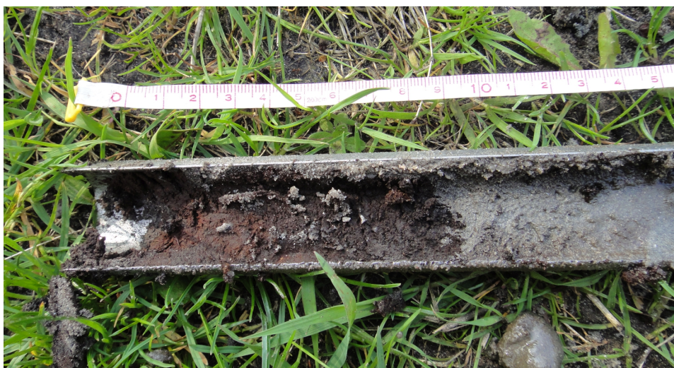
Afbeelding 5. Inhoud guts van boring 1 met scherpe grens tussen het opgebrachte zand en de top van het veen.
