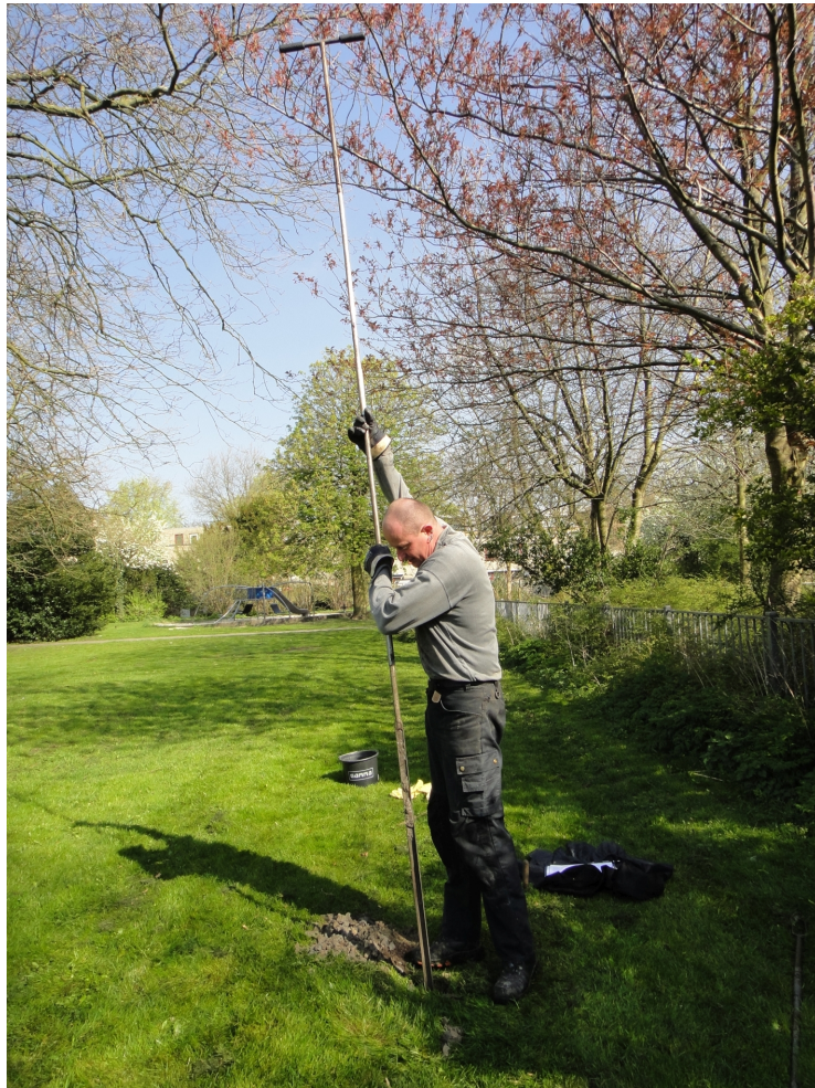
Afbeelding 3. Guthsboring op boorpunt 2.
