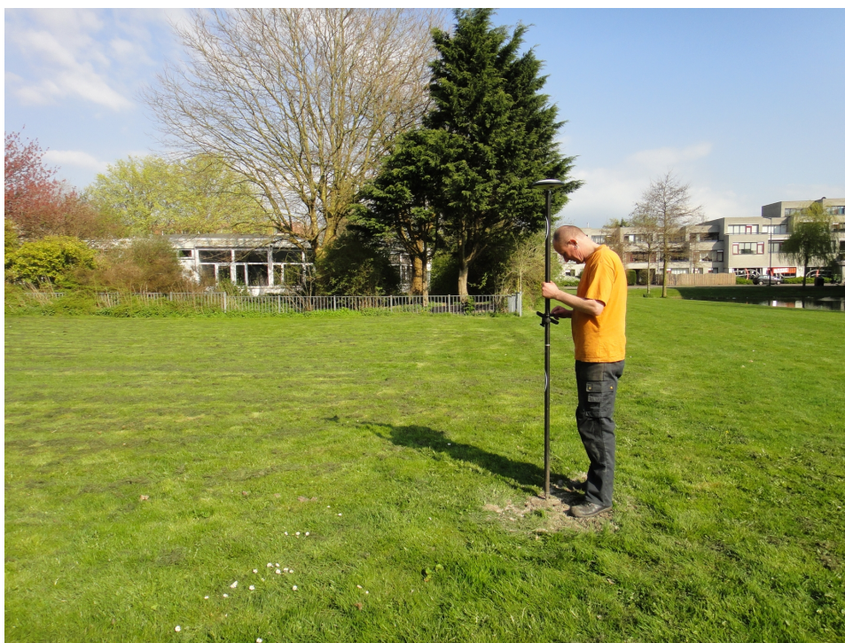
Afbeelding 4. Digitaal inmeten van boorpunt 4.
